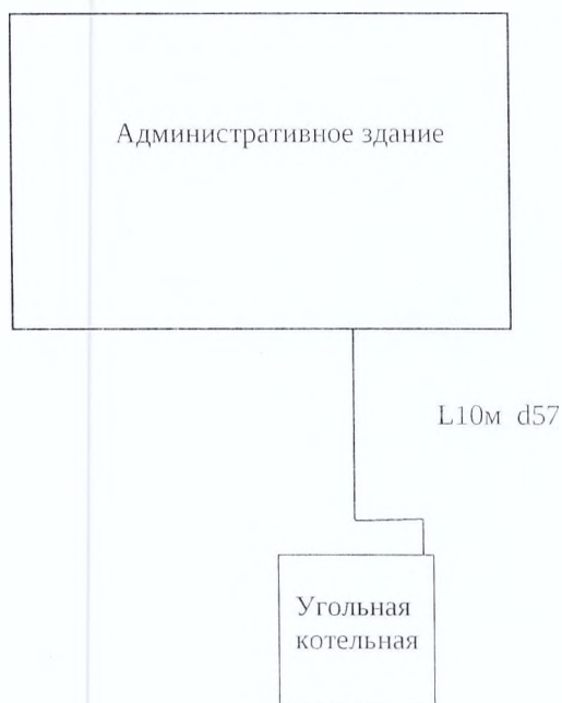
Рисунок 8. Схема теплотрассы угольной котельной с.Сосновское
